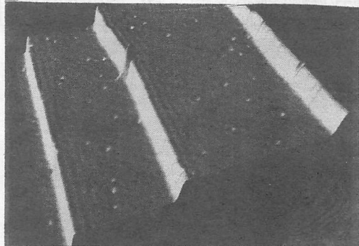
図26. Cu(111)清浄表面のconstant-current像( V_t=0.1V , I_t=1.0nA 、温度 4.2K [17]。
